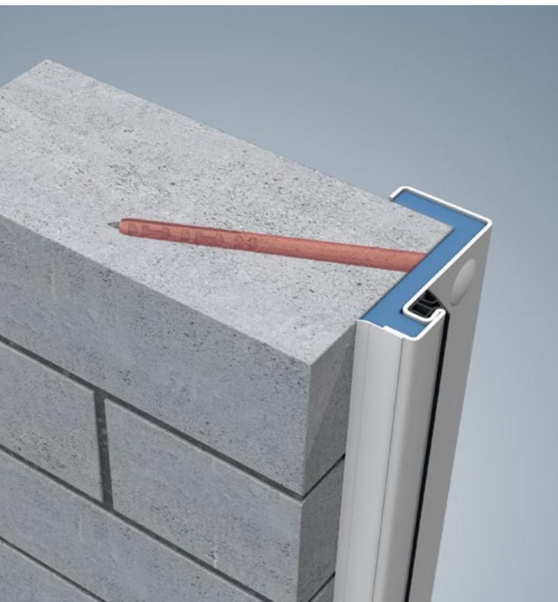
Die stumpf einschlagende NovoPorta Plano wird standardmäßig mit Eckzarge ohne Bodeneinstand geliefert. Das bietet alle Möglichkeiten für die effiziente Falz-Schraubmontage an Wände aus Sichtmauerwerk, Beton und (nur für die Plano zugelassen) auch Porenbeton.
