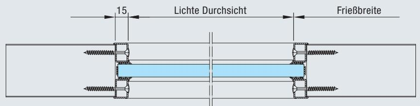
Verglasung mit stumpfem Stahlprofil für Rechteckverglasung (nur bei MZ und EI<sub>2</sub>30 Türen möglich)
