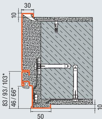
Eck- und Ergänzungszarge mit Dübelmontage (Mauerwerk / Beton)
