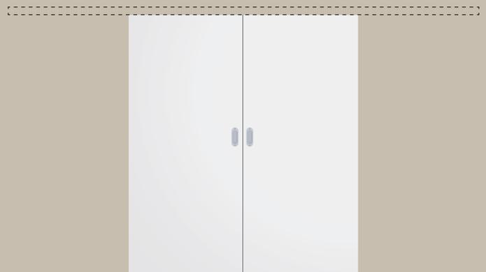
In der Wand laufend: Türblatt wird in eine bauseitige Türtasche in der Wand eingeschoben, die Zarge verkleidet die Wandöffnung komplett.
