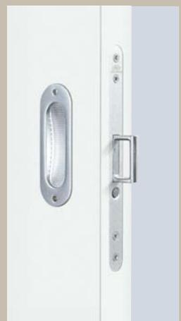
Mit einem Springgriff können Sie das Türblatt bei in der Wand laufenden Schiebetüren komplett in die Wand schieben. Auf Knopfdruck springt der Griff heraus und Sie können die Tür schließen.
