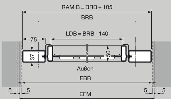
Vertikalschnitt Tor mit unterem Anschlag
