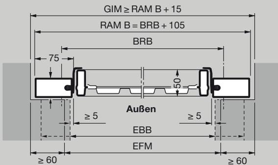
Vertikalschnitt Tor mit unterem Anschlag
