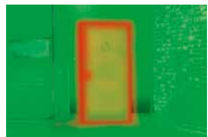
Sichtbarer Energieverlust ohne thermisch getrennte Tür
