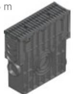
Einlaufkasten mit Kunststoff-Eimer und Guss-Längsstabrost SA 9 mm, KTL-beschichtet, Klasse C 250, arretiert, 0,5 m
