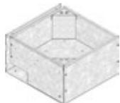
Revisionskasten mit entnehmbarer Innenwanne, Typ 180, Halshöhe 130 mm, asymmetrisch
