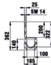
Halshöhe 200 mm, asymmetrisch, Klasse D 400, FASERFIX STANDARD E 100
