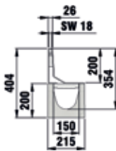
Halshöhe 200 mm, asymmetrisch, Klasse E 600, FASERFIX KS 150
