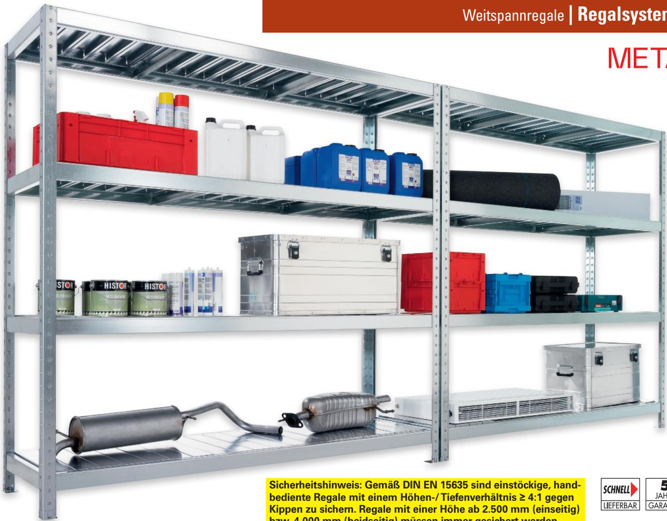
**Sicherheitshinweis:** Gemäß DIN EN 15635 sind einstöckige, handbediente Regale mit einem Höhen-/ Tiefenverhältnis  $\geq 4:1$  gegen Kippen zu sichern. Regale mit einer Höhe ab 2.500 mm (einseitig) bzw. 4.000 mm (beidseitig) müssen immer gesichert werden.
