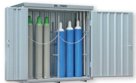
Gebaut nach der TRGS 510 mit der dazugehörigen Beurteilung des TÜV Rheinland können in diesem geschlossenen Gasflaschen-Lagercontainer Gasflaschen auch ohne den Einbau eines zusätzlichen Lüfters gelagert werden, sauber, sicher und dennoch so gut belüftet wie in einer Drahtgitterkonstruktion durch einen zusätzlich unterlüfteten Boden in Verbindung mit den Lüftungskiemern.
