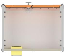
Havarie der Batterie startet, Zellen stoßen entzündbare Dämpfe aus, die sich im Schrank verteilen.
