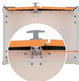
Mit Auftreten einer Zündquelle (ggfs. durch Funken der Batterie selbst) kommt es zur Explosion/Gasdurchzündung. Der lockEX-Mechanismus baut die Explosionsenergie durch einen schmalen Spalt kontrolliert ab.
