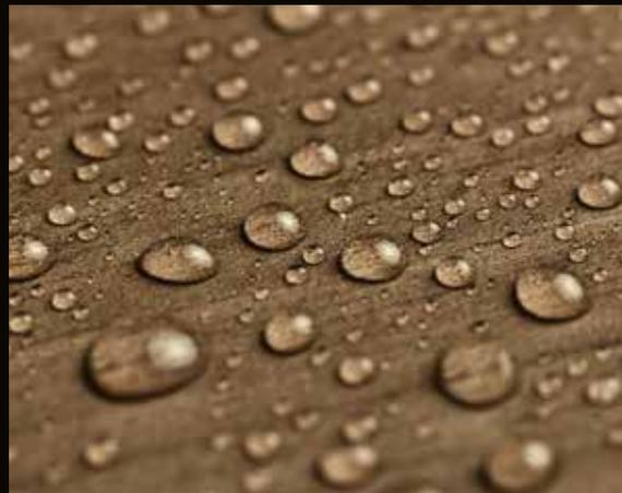
Die geschlossene Oberfläche ist das Ergebnis der von Trespa entwickelten Elektronenstrahl-Härtung (EBC). Nur so ist das Material in der Lage, den Schmutz abzuweisen, Abtönungseffekte zu vermeiden und zugleich die Farben zu schützen.
