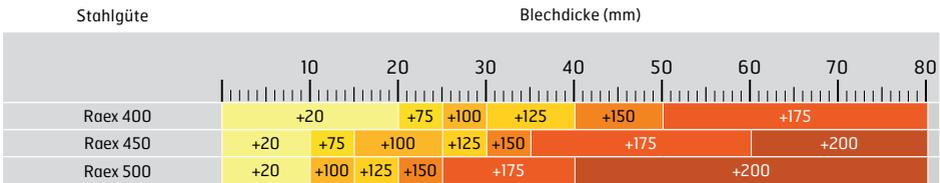
HINWEIS: Arbeits- und Zwischenlagentemperaturen von über +220 °C sollten nicht eingesetzt werden.
