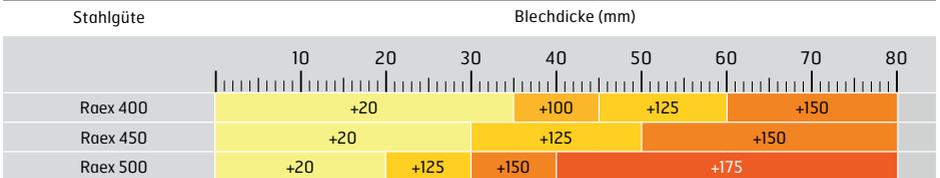
HINWEIS: Vorwärmen kann durch Verringern der Schnittgeschwindigkeit und der entsprechenden Wahl von Düsen und anderen Schneid-
