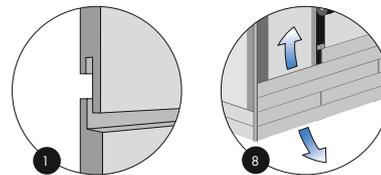
Das System enthält einen Belüftungsabstand zwischen dem tragenden Mauerwerk und den Paneelen und vermeidet so Hitzestau und Feuchtigkeitsbildung.
