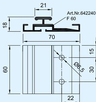
Flachsoganker aus stranggepressten Aluminiumprofilen zur gleitenden Befestigung an der innenseitigen Sogankernut der Lichtbauelemente mit den Querpfeifen der Hinterkonstruktion, fortlaufende wirtschaftliche Montage von außen, deutlich erhöhte Sogwiderstandswerte in zwei Größen (F60 mit 60 mm Länge und F120 mit 120 mm Länge).
