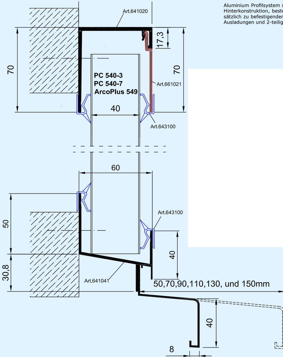
Aluminium Profilsystem (VF) zur Befestigung vor einer Hinterkonstruktion, bestehend aus Fußprofilen mit zusätzlich zu befestigenden Wetterschenkeln in variablen Ausladungen und 2-teiligen Rahmenprofilen.
