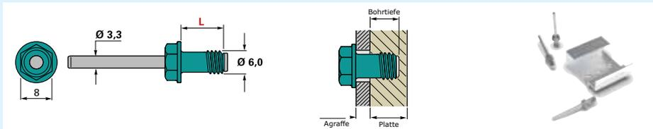
TW-S Befestiger für sichtbare Befestigung auf Holz; Nieten in entsprechender Farbe lackiert. SDA5 der Allrounder für die Aluminium-Unterkonstruktion; Fix- und Gleitpunkt mit einer Schraube - 3,5 bis 8,0 mm Klemmbereich.
