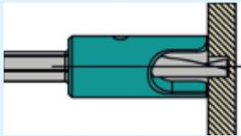
1. Vorbohren der HPL-Fassadenplatte mit dem HSS Sacklochbohrer  $\varnothing$  6 mm mit Tiefenanschlag
