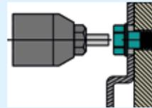
3. Zugstift mit Nietsetzgerät GESIPA PowerBird® Pro vollständig abziehen (Mundstück 17/ 36 oder 17/40)
