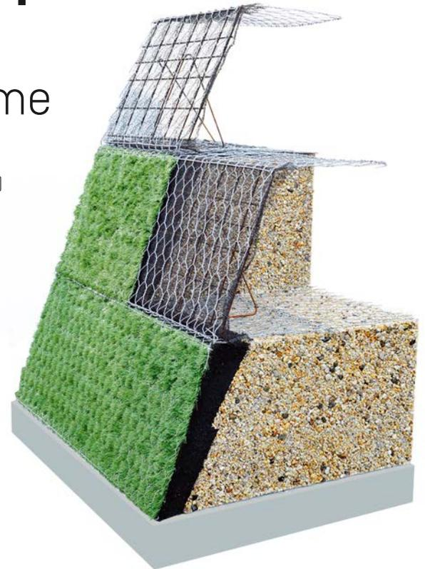
**GREEN TERRAMESH** – das rückverankerte, begrünbare Steilböschungssicherungssystem: Die Montage wird nach dem Umschlagprinzip ausgeführt. Das Stahldrahtgeflecht umhüllt die darüberliegende Bodenschicht. Neigung bis 70°.
