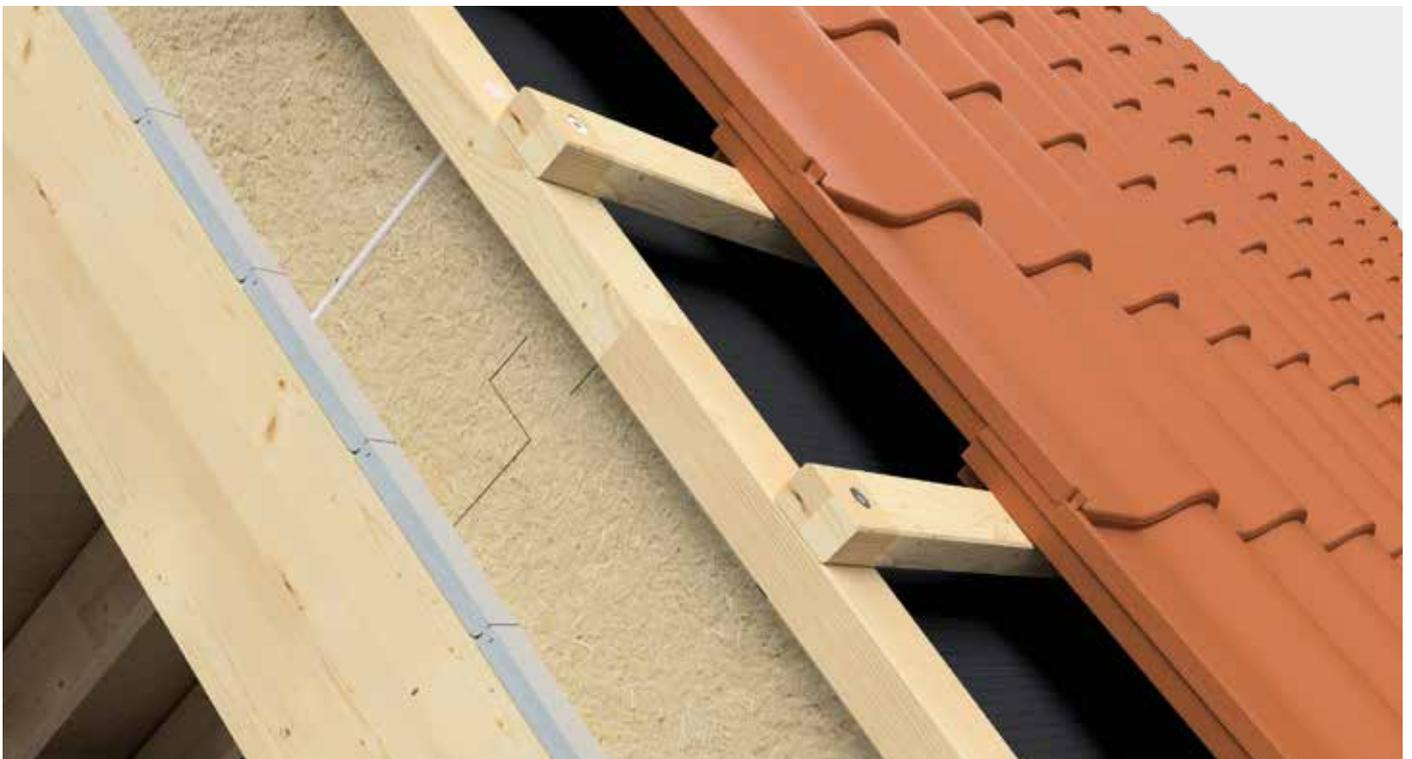
Nur geeignet für Dämmstoffe  $\geq 50$  kPa (druckfest)
