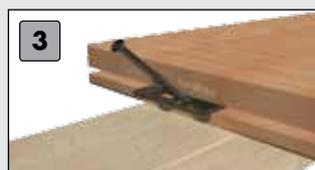
3 Den Decking Clip an der vorgebohrten Stelle anbringen, indem Sie die Schraube durch den Decking Clip führen. Setzen Sie den gleichen Vorgang an jeder Balkenposition für jedes Brett fort.
