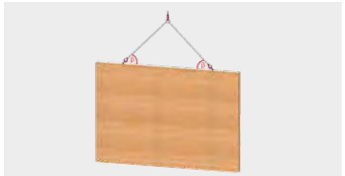
BSH-Wand oder-Träger stehend, Faserverlauf: vertikal
