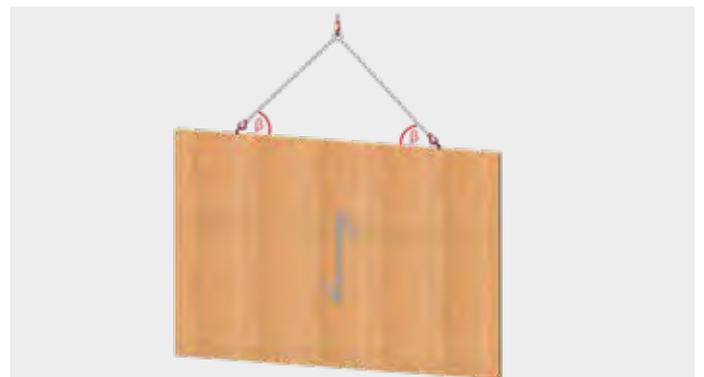
BSH-Wand oder-Träger stehend, Faserverlauf: vertikal
