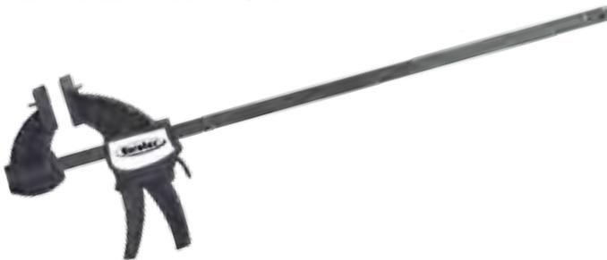
Die Spannzwinde ist ein unerlässliches Hilfsmittel zur Verlegung der Terrassendielen. Verwenden Sie mindestens 4 Spannzwingen, um die Dielen auf ihrer ganzen Länge in Form zu bringen. Zusammen mit z. B. den Abstandhaltern wird so ein gleichmäßiges Fugenbild mit gerade verlaufenden Terrassendielen erreicht.
