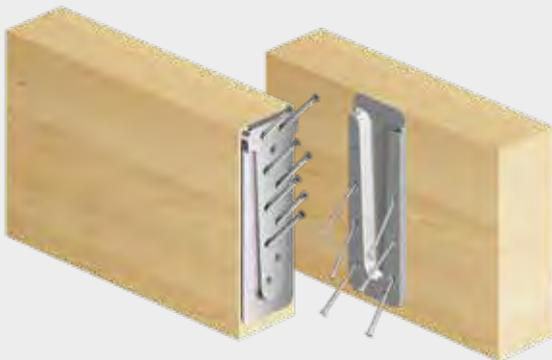
**3** Nebenträger am Hauptträger einhängen, Anschluss mit Fixierschrauben gegen Herausheben sichern
