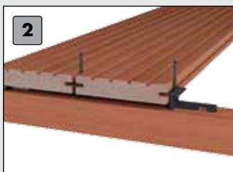
Ausrichten und Fixieren der nächsten Dielen, mit dem T-Stick die Verschraubung vornehmen bis alle Dielen befestigt sind.
