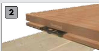
2 Eurotec Decking Clip auf der Unterkonstruktion an bringen und am unteren Schenkel der vorgenuteten Terrassendiele in einem 45°-Winkel vorbohren. Verwenden Sie den mitgelieferten 3 mm Bohrer.
