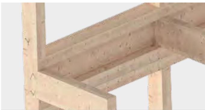
Befestigung von Stützen bei Holz-Rahmenkonstruktionen sowie Haupt-/Nebenträger-Anschlüssen
