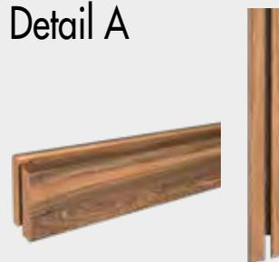
Bei einer senkrechten Verlegung muss bei der Anwendung des Fassadenclips-Rhombus Starter folgendes vorbereitet werden. Wir empfehlen für die Ausbildung einer Tropfkante des Rhombus Profils, eine 15° Unterschneidung auszuführen. Mit einer 4 mm breiten fachgerechten Einschlitzung des Holzprofils fügt sich der Fassadenclip-Rhombus Starter passgenau an (s. Detail A).
