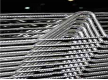
Gitterträger sind zwei oder dreidimensionale, industriell vorgefertigte Bewehrungselemente. Sie bestehen aus einem Obergurt und einem, mehreren Untergurt(en) sowie kontinuierlich verlaufenden oder unterbrochenen Diagonalen. Diese sind durch Schweißen mit den Gurten verbunden.
