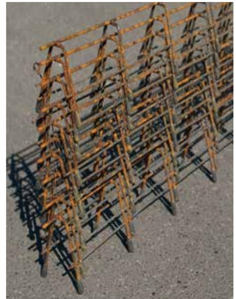
Standard Unterstützungskörbe mit Kunststoff-Füßchen auch genannt BK-Körbe stehen auf der Schalung oder Sauberkeitsschicht. Sie werden daher in Bauteilen eingesetzt, die keine besonderen Anforderungen an die Betonoberfläche stellen und eine Beschädigung des Untergrundes (Aufstandsfläche) durch Eindrücken oder Durchstanzen ausgeschlossen werden kann (z. B. Folien unter Bodenplatten).
