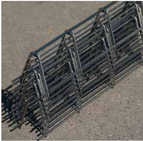
BT-Körbe stehen auf der unteren Bewehrung und garantieren daher die Unversehrtheit des Untergrundes (Schalung). Sie können somit auch in Bauteilen eingesetzt werden, die besondere Anforderungen an die Betonoberfläche stellen (z. B. Deckenuntersicht als Sichtbeton).
