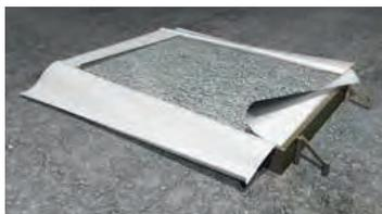
**MISAPOR wird auf das Geotextil geschüttet,** mit Rechen oder Bagger gleichmässig verteilt und anschliessend mit geeigneter Rüttelplatte um Faktor 1,3:1 verdichtet. Anschliessend wird das Geotextil über die fertig verdichtete Schüttung eingeschlagen, so dass der Frostschirm rundum eingepackt ist.
