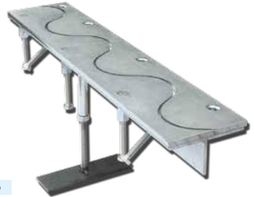
HSD® Schwerlastfugenprofil aus Stahl, Stahl verzinkt (vz) oder Edelstahl (VA) für die Ausbildung und als Schutz von Fugen vor Beschädigungen im Übergang von vorhandenen (Bestand) zu neuen Betonnutzböden im Rauminnen. Die Fugenausbildung als Sinuswelle garantiert durch ununterbrochenen Kontakt der Laufräder mit dem Schwerlastfugenprofil ("System Fugenlos") ein erschütterungsfreies Überfahren mit Flurförderfahrzeugen unabhängig von Größe und Härte der Bereifung.
