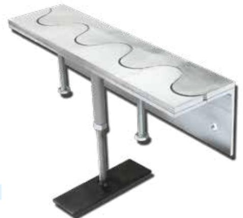
HSD®Schwerlastfugenprofil aus Stahl, Stahl verzinkt (vz) oder Edelstahl (VA) für die Ausbildung und als Schutz von Fugen vor Beschädigungen im Übergang von vorhandenen (Bestand) zu neuen Betonnutzböden im Rauminnen. Die Fugenausbildung als Sinuswelle garantiert durch ununterbrochenen Kontakt der Laufräder mit dem Schwerlastfugenprofil ("System Fugenlos") ein erschütterungsfreies Überfahren mit Flurförderfahrzeugen unabhängig von Größe und Härte der Bereifung.
