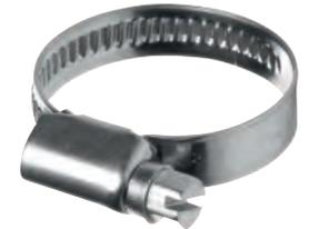
**Schlauchschelle nach DIN3017 · Werkstoff (W1) verzinkt · Sechskantschraube SW 7 · Schneckenwinde**
