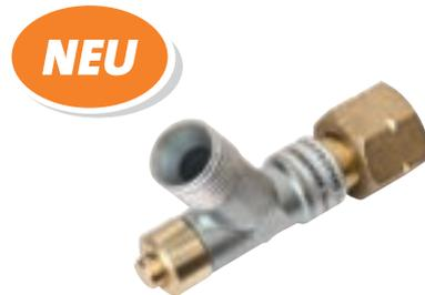
**Schlauchbruchsicherung für Propangas** · vorgeschriebenes Sicherheitselement im gewerblichen Einsatz · für den Betrieb von Gasgeräten mit Schlauchlängen von über 5 m · stoppt sofort die Gaszufuhr bei Schlauchbeschädigungen · DVGW-geprüft · Anschluss: 2 x G 3/8" LH · passend zu Art.-Nr. 40 00 872 016
