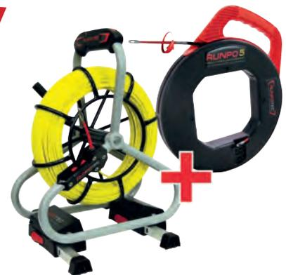
**RUNPO 5:** 30 m - optimales Einsatzgebiet Rohrdimensionen 16 - 40 mm - 3-fach vedrillter Spezialkunststoff mit 2 x RUNPOGLEITER inkl. Drallausgleich am Spiralanfang und Spiralende dadurch optimales Biege- und Gleitverhalten - nahezu Bruchfrei - Gesamtzuglast 270 kg - in Kunststoffbox
