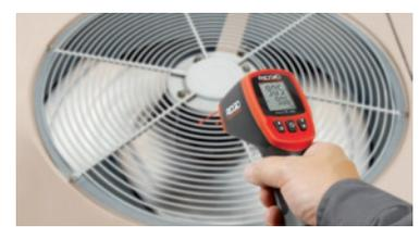
**Infrarotthermometer micro IR-200**
