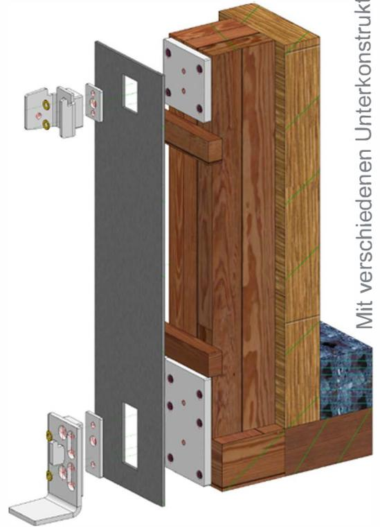
Mit verschiedenen Unterkonstruktionen schließen wir an JEDER Holzkonstruktion an!
