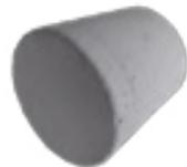
Vorgefertigter Kegel in hochwertiger Sichtbetonqualität zum Verschluss von Spannstellen. Nach dem Entfernen des Konus K22/5 wird der Sichtbetonkegel in die konische Öffnung eingeklebt. Der Kegel ist etwas kürzer als die konische Öffnung, dadurch wird die Ausbildung einer Schattenfuge erreicht.
