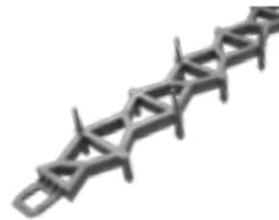
Abstandhalter für leichte Bewehrung mit sehr gutem Betondurchfluss. Durch spezielle FüÙe geringer Kontakt zur Schalung. Nach oben stehende Noppen verhindern das Verrutschen der Bewehrung. Lieferung auch ohne Noppen möglich. Durch Steckkupplung beliebig zu verlängern.
