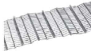
Putzträger tafel aus verzinktem Stahlblech. Durch enge Maschen wird eine bessere Putzverankerung gewährleistet. Durch die 8mm hohen Rippen sehr robust und widerstandsfähig, trotzdem leicht verformbar. Sehr anpassungsfähig an alle geometrischen Formen.
