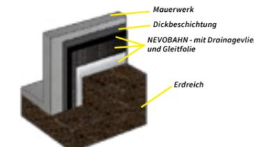
**Einsatz bei Grundmauerschutz**
