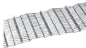
Putzträger tafel aus verzinktem Stahlblech. Optimal für dünne Putzschichten geeignet. Durch die 4mm hohen Rippen sehr stabil und trotzdem leicht verformbar. Sehr anpassungsfähig an alle geometrischen Formen.
